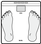
ส้นเท้าจะต้องวางอยู่ตรงจุดกึ่งกลางของขั้วไฟฟ้า
